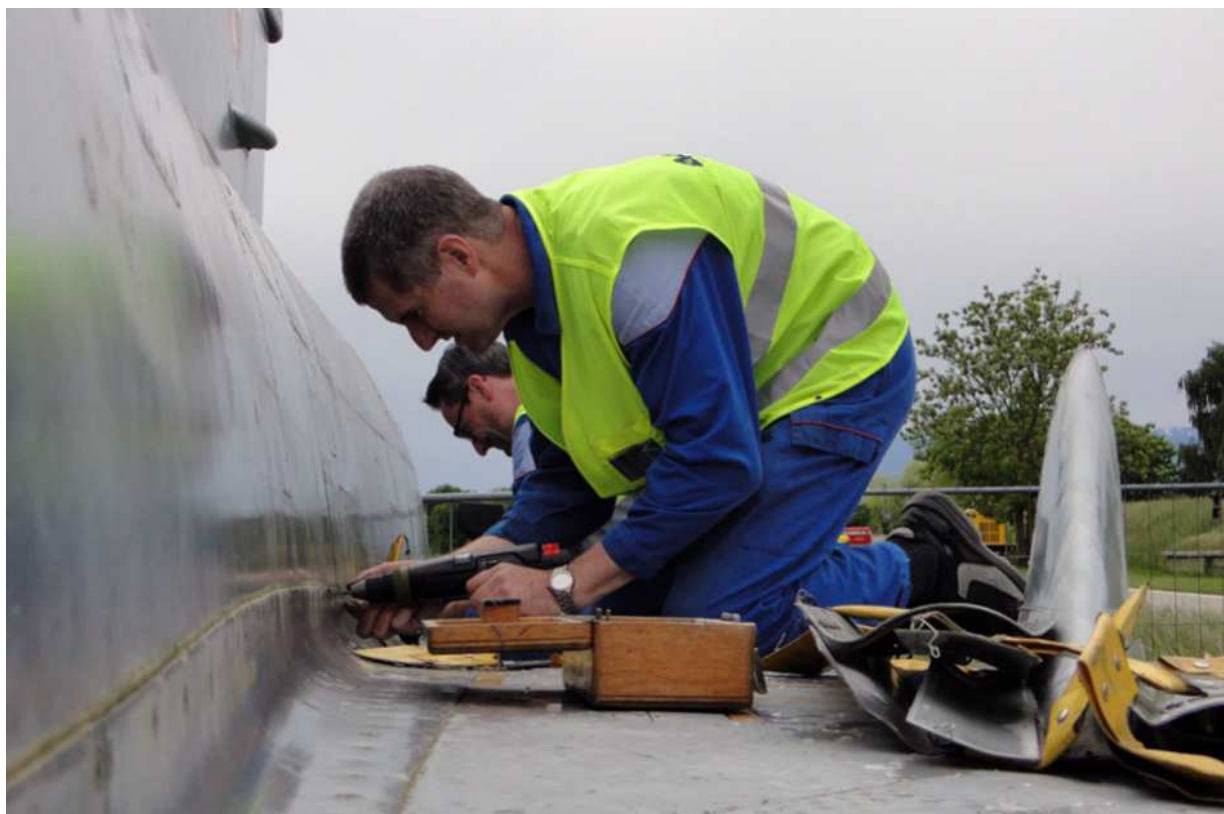
Die Flügel der Mirage werden abgenommen... Bruno Kreuzer, TK Chef Mirage Verein und Beat Waser bei der Arbeit
