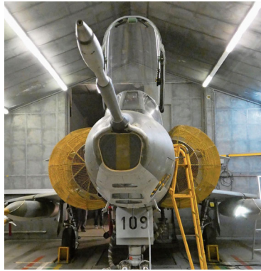
Der Mirage-Aufklärer R-2109 im Bremshaus während des Triebwerk-Standlaufs. Bild: FW
